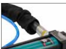
Der Berstschutzschlauch gehört zur Standard-Ausstattung der Schlauchpakete für die BES und PHA Druckübersetzer und erfüllt die geltende Pressen C-Norm EN 16092-1.
