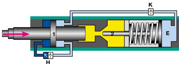
Luftbetriebener **Rückhub**: Nach Umschalten des Hauptsteuerventils (**H**) entlüftet das Krafthubventil (**K**) den Raum (**E**) automatisch. Der Übersetzerkolben (**2**) wird durch Federkraft zurück gedrückt und der Arbeitskolben (**1**) fährt pneumatisch in die Ausgangsposition zurück.
