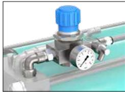
Die **externe Krafthubzuschaltung ZKHZ** realisiert die Zuschaltung des Krafthubventils mittels elektrisch betätigtem 3/2-Wegeventil. Dies wird bei wegabhängiger Krafthubzuschaltung oder bei anwendungsbedingt unterbrochenem Eilhub empfohlen. Ebenfalls sinnvoll ist die ZKHZ bei Einsatz des TOX® Kraftpakets mit nach oben gerichteter Kolbenstange und großem Werkzeuggewicht.
