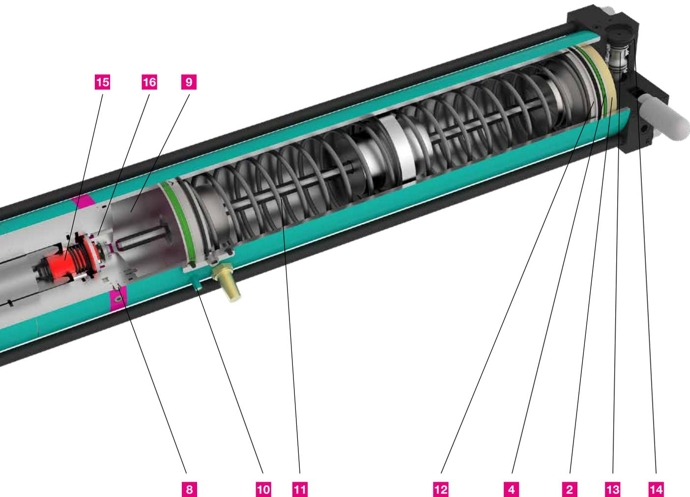
**13** Die Umsteuerung von Eil- auf Krafthub erfolgt automatisch, wenn der Arbeitskolben an beliebiger Stelle des Hubs auf Widerstand trifft. Das **Krafthubventil** ist mit dem Rückhubraum verbunden und funktioniert nach dem Staudruckverfahren. Die Umschaltzeit wird mit der Steuerdrossel X reguliert.
