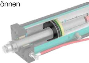
Der Wegaufnehmer gibt die absolute Ist-Position des TOX® Kraftpaket-Kolbens an. Das **Wegmesssystem ZHW/ZKW** kann sowohl extern (ZHW) als auch intern (ZKW) angebaut werden. Es arbeitet berührungslos, ist deshalb verschleißfrei und unempfindlich gegen Verschmutzung und Störfelder.
