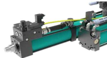
Die **Schnittschlag-Dämpfung ZSD** dämpft den Arbeitskolben bei Wegfall der Gegenkraft, zum Beispiel bei Stanzanwendungen. Als rein mechanische Dämpfung kann sie mit Einschränkungen auch als Hub-Dämpfung eingesetzt werden.
