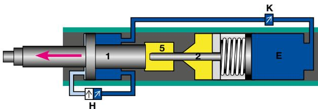
Pneumohydraulischer **Krafthub**: Der Übersetzerkolben (**2**) schließt die Hochdruckkammer (**5**) und erhöht den Öldruck im Arbeitsbereich auf bis zu 400 bar. Dieser Öldruck wirkt auf die Rückseite des Arbeitskolbens (**1**) und löst den Krafthub aus.
