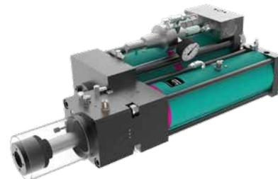
Die **Haltebremse „Safety Lock“ ZSL** wirkt bei Druckabfall und verhindert das Absenken und Ausfahren des Arbeitskolbens. Sie funktioniert mit mechanischen Fangbacken und kann nur durch Druckbeaufschlagung wieder gelöst werden. Die Haltebremse ist von der Berufsgenossenschaft geprüft.
