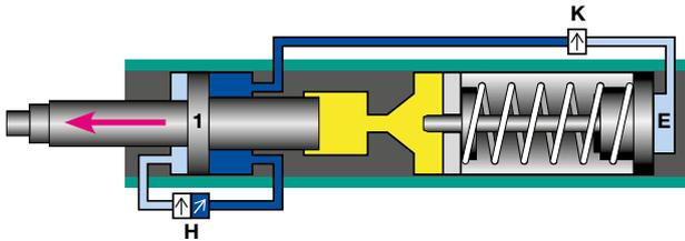
Luftbetriebener **Eilhub**: Das Hauptsteuerventil (**H**) wird betätigt. Der Arbeitskolben (**1**) fährt im Eilhub aus, bis er an einer beliebigen Stelle auf eine Gegenkraft stößt. Er stoppt, und das Krafthubventil (**K**) schaltet um. Luft strömt nun in den Raum (**E**).
