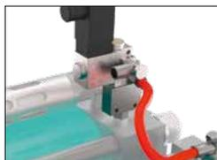
Die **Hubfrequenzoptimierung ZHO** ist eine optionale Zusatzbaugruppe zur Verbesserung der Zykluszeit (Zeitgewinn ca. 20 Prozent) und ersetzt das vorhandene Krafthubventil durch ein Ventil der nächsten Baugröße.
