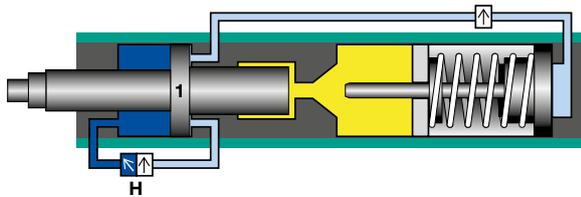
In **Grundstellung** muss der Antrieb über das Hauptsteuerventil (**H**) im Rückhub angesteuert sein. Der Arbeitskolben (**1**) ist eingefahren.
